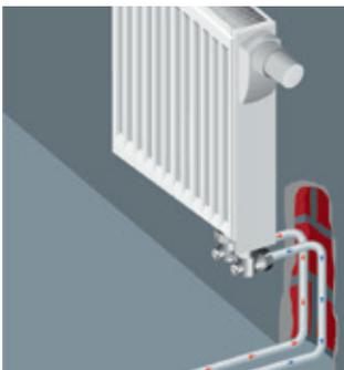
Anschluss eines Ventilheizkörpers mit metalplast mittels einer UNI-Verschraubung aus der Wand.
