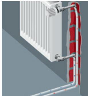
Anschluss eines Heizkörpers mit Press-Anschlusswinkel aus der Wand.
