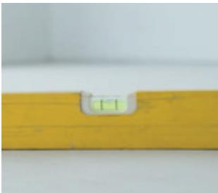
Untergrund muss trocken, tragfähig und eben sein (Toleranz von max. 3 mm pro m). Unebenheiten ggf. vorab ausgleichen.
