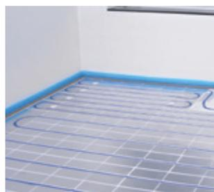
Fertig verlegte Fläche System compact-plus 30. Bis zur Verlegung der Lastverteilschicht oder des Oberbodens Laufwege, z. B. mit Dämmplatten, vor Stauchung schützen. Der Oberboden kann direkt verlegt werden.
