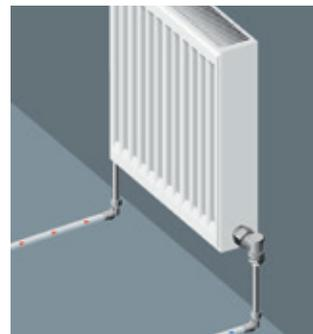
Anschluss eines Ventilheizkörpers mit Press-Anschlusswinkel aus dem Boden.
